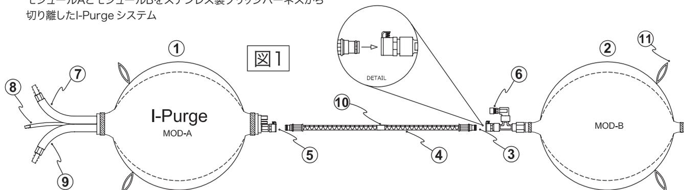
1. モジュールA: モジュールAにはガスの入口と出口があります。モジュールAにはブラダー径が印字されています。
